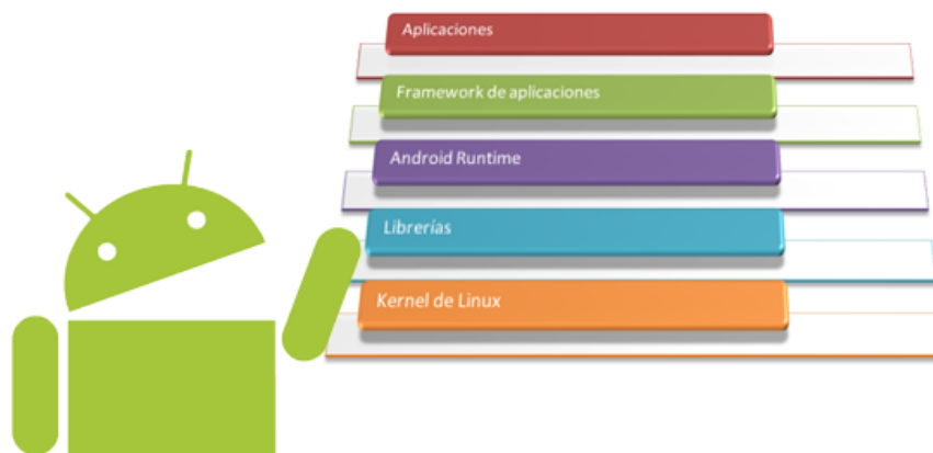
Figura 3.3.- Esquema de capas del sistema Android
