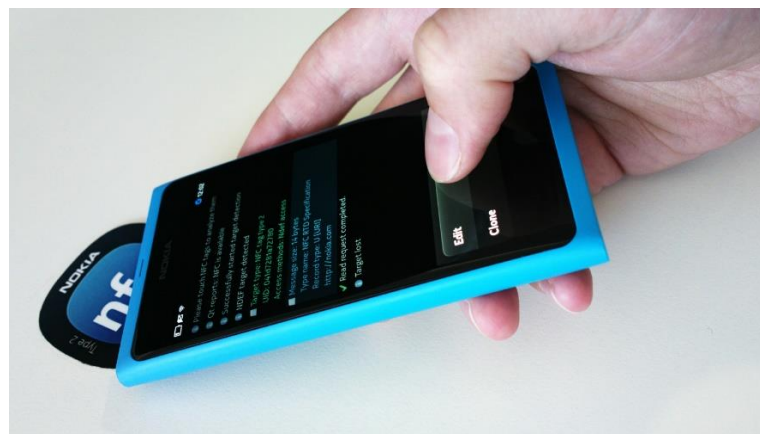
Figura 2.2.- Ejemplo NFC en modo pasivo
