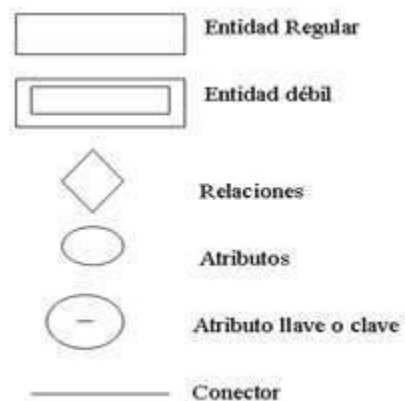
Figura 4.20.- Elementos de un diagrama entidad-relación
