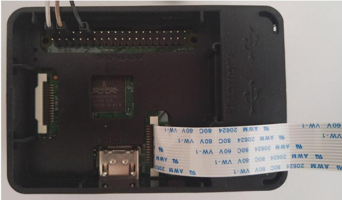
Ilustración A1 1: Conexión sensor PIR y cámara
