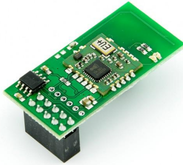
Ilustración 12 – Módulo controlador RaZberry para Raspberry Pi
