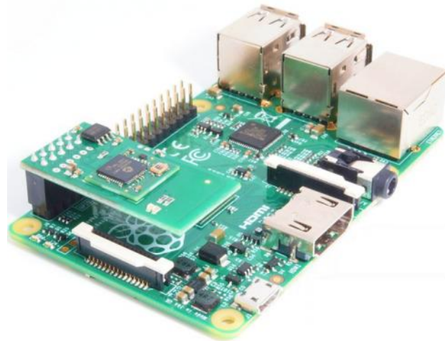
Ilustración 13 - Módulo acoplado a la Raspberry Pi
