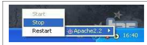
Figura 11. Parar la ejecución de Apache
