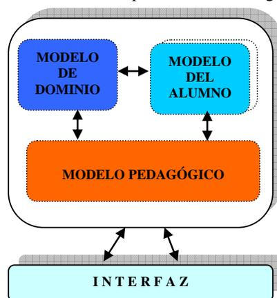
**Fig. 1.** Arquitectura esquemática genérica de un STI.
