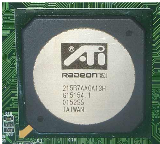
Figura 5. Circuito integrado ATI Radeon 8500.
