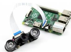
Figura 3.27: Cámara Raspberry Pi
