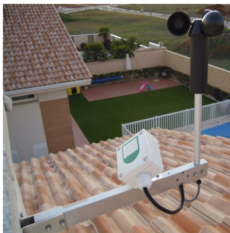
Figura 3.2: Sensor exterior y anemómetro
